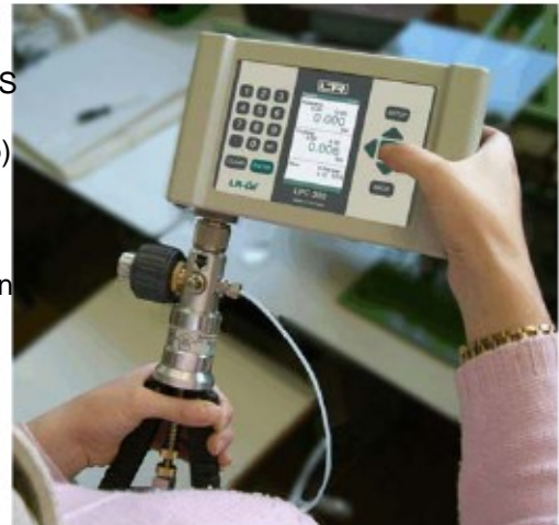
LPC 300 với bơm tạo áp cầm tay LPP 30 "on site"
